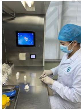
图1 分剂量操作示意图（垂直层流洁净操作台）
